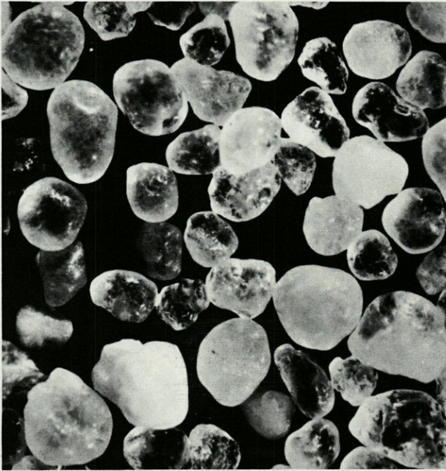
FIG. 6. — Sable siliceux d'Arcachon, grains subsphériques diamètre moyen compris entre 275 et 325 microns ( \times 75 ).
